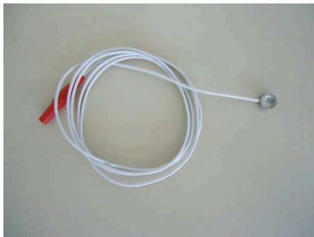
Figura 4.1: Eletrodos de estanho. Fonte: Elaborado pelo autor.
