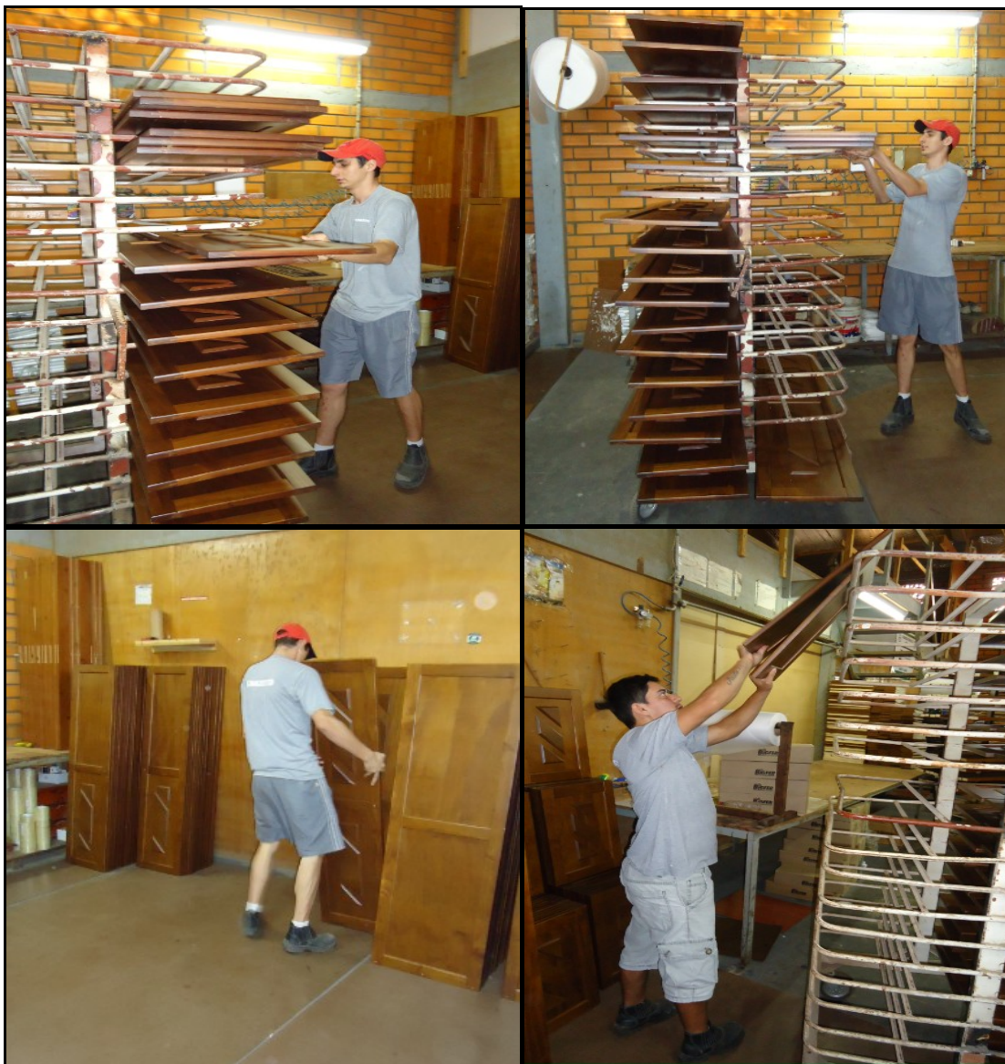
Figura 18 – Descarregar as grades de secagem.
