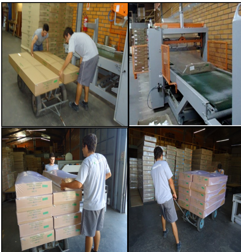
Figura 28 – Alimentar e recolher os volumes na máquina termoencolhível.
