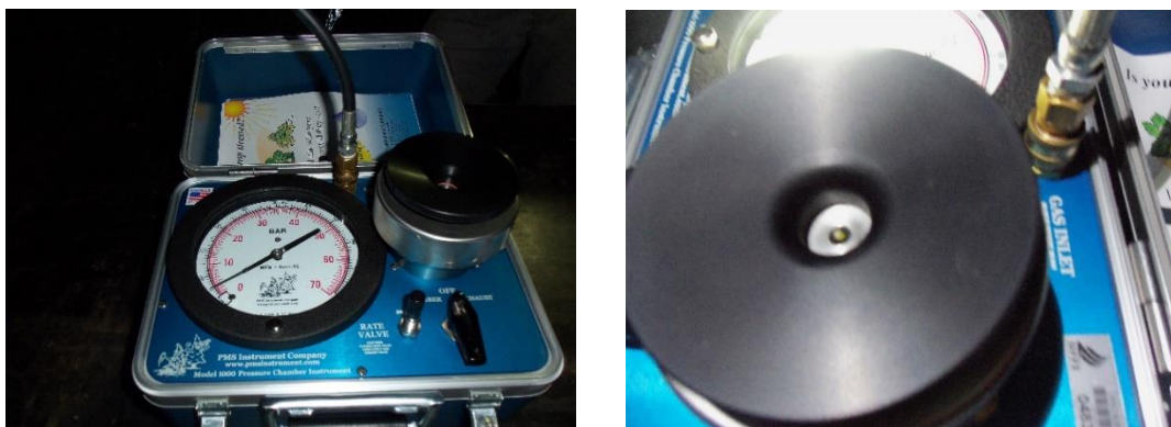
Figura 13_ Câmara de pressão tipo Scholander, utilizada para determinar o potencial hídrico xilemático das plantas estudadas.
