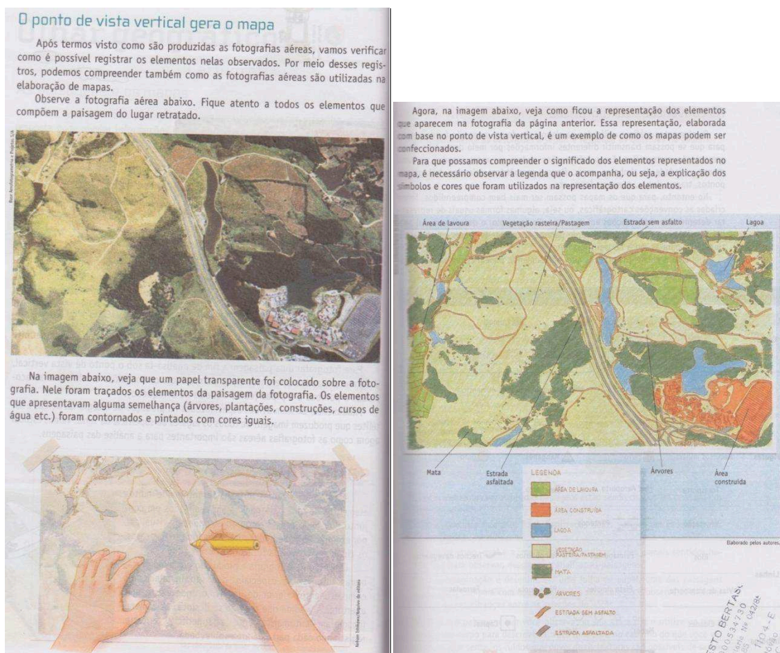
Figura 7: Exemplo de confecção de um mapa a partir de uma fotografia aérea.
