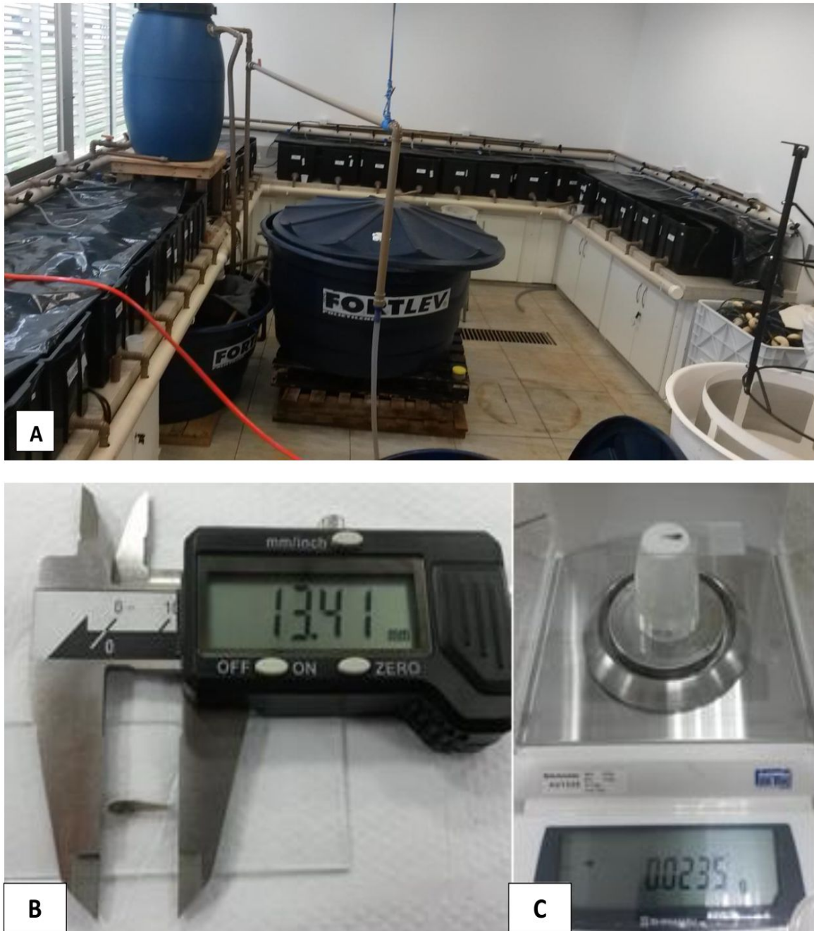
Figura 3 - Vista geral do sistema experimental (A); Aferimento do comprimento total (B) e peso inicial das pós-larvas (C).
