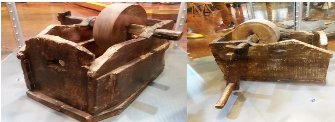
Figura 12 - Rebolo para afiação de ferramentas para fazer a derrubada da mata, utilizado pelos agricultores por várias décadas
