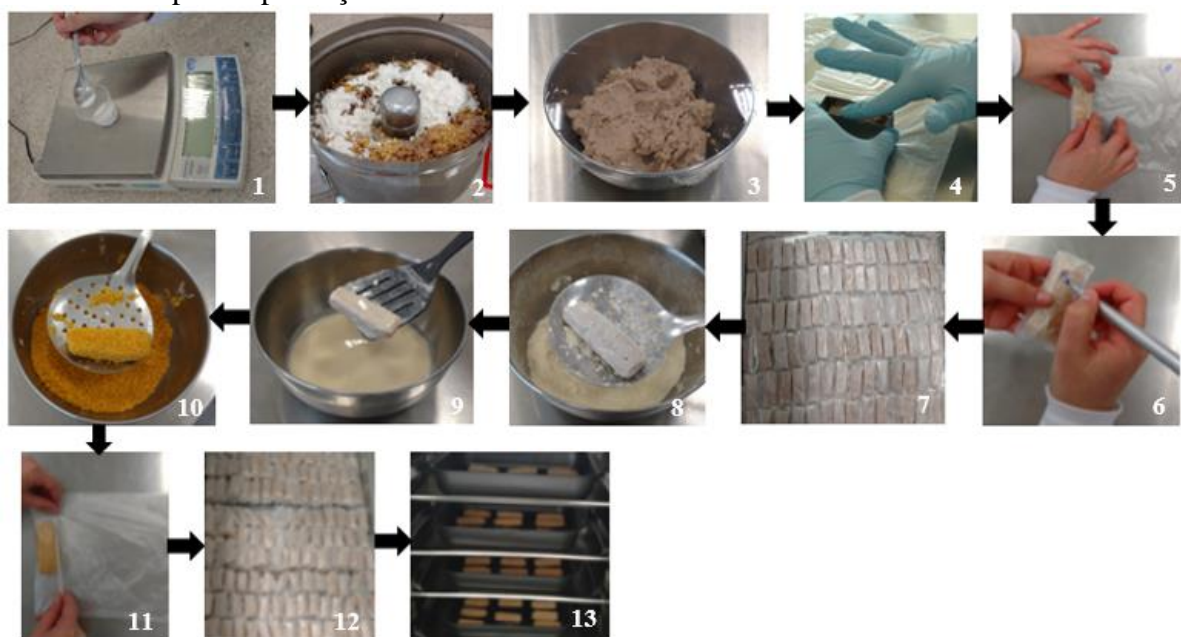
Figura 1 - Fluxograma do processamento de tirinhas empanadas de tilápia, ilustrando as diferentes etapas de produção.
