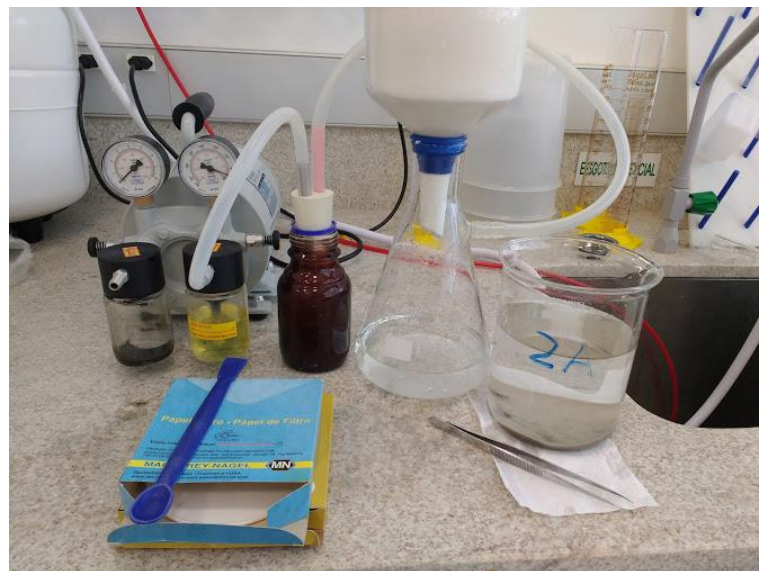
Figura 7: Filtração ocorrendo com auxílio da bomba de filtração à vácuo, para obtenção de extrato lixiviado.
