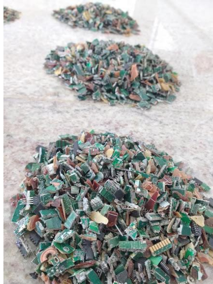
Figura 2: Resíduo eletrônico classificado após execução da análise granulométrica.
