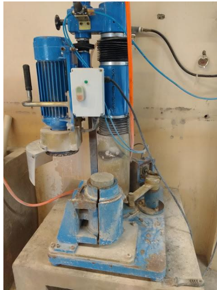
Figura 4: Retificador de corpos-de-prova do Laboratório de Construções da URI, utilizado no ensaio, para padronização das amostras.
