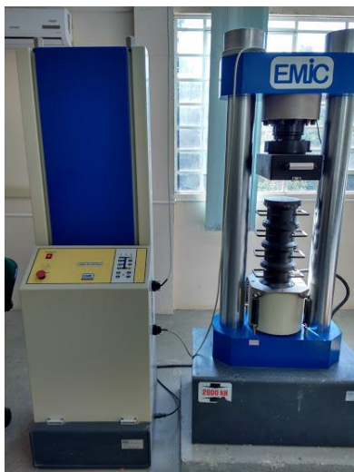
Figura 5: Prensa Hidráulica com potência de até 2000kN, utilizada para ruptura dos corpos-de-prova.
