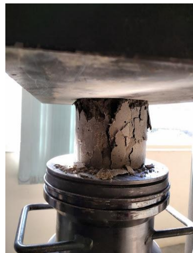
Figura 6: Execução do ensaio de resistência à compressão simples, realizado no Laboratório de Construções da URI – Campus II – Erechim.
