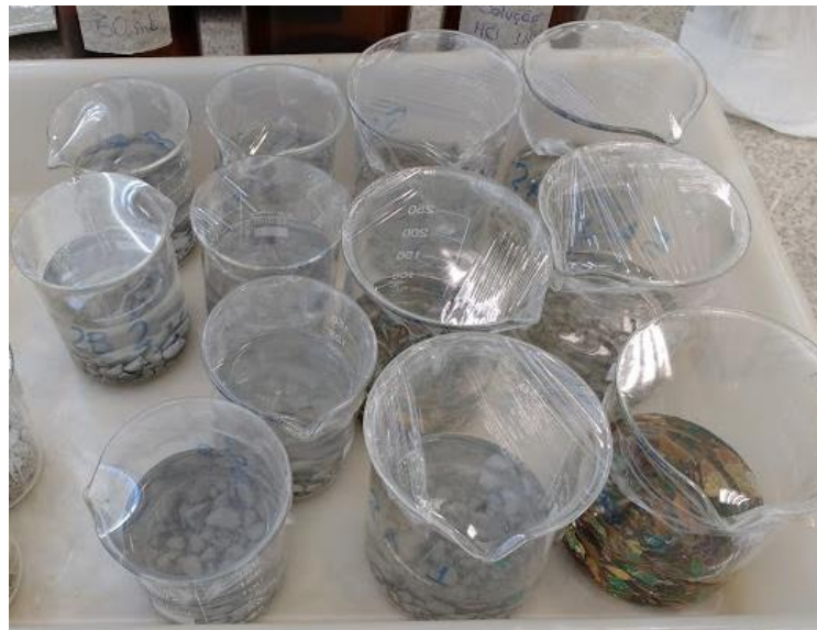
Figura 8: Amostras de ensaio de solubilização em repouso em água deionizada por 7 dias, para posterior filtração e análise.
