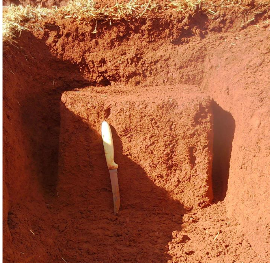
Figura 15 - Visualização do processo de retirada da amostra indeformada, vista lateral.
