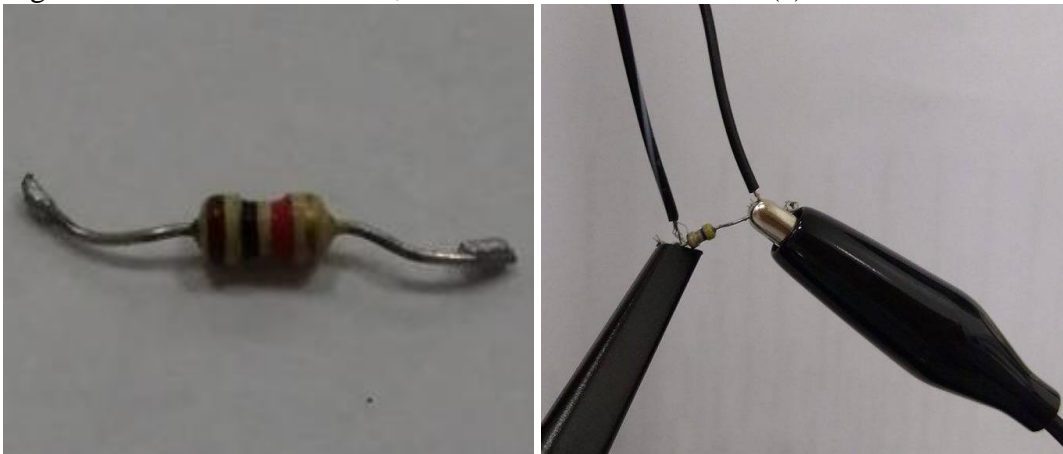
Figura 36 - Modelo de resistor, através das faixas coloridas (a) e modo de circuito (b)
