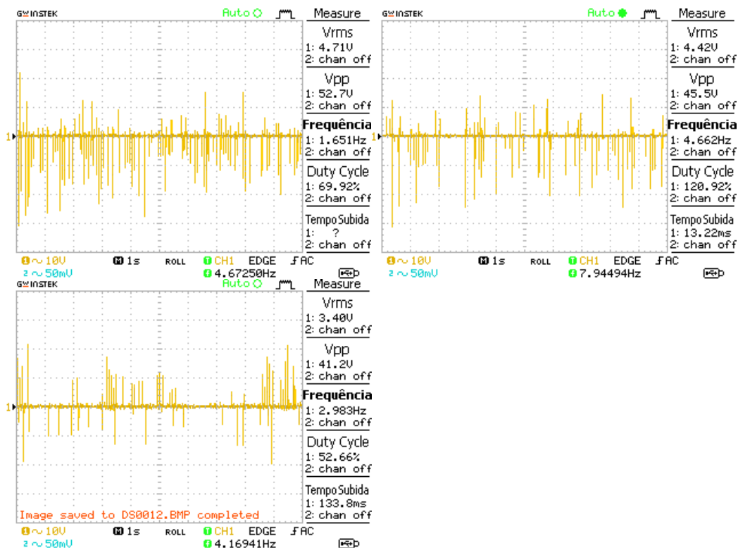
Figura 57 - Respostas das voltagens pela CG2 na PGa com a viga de alumínio através da V_{v1}
