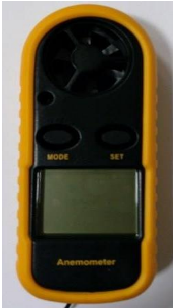
Figura 31 - Modelo de anemômetro digital para mensurar a velocidade do vento
