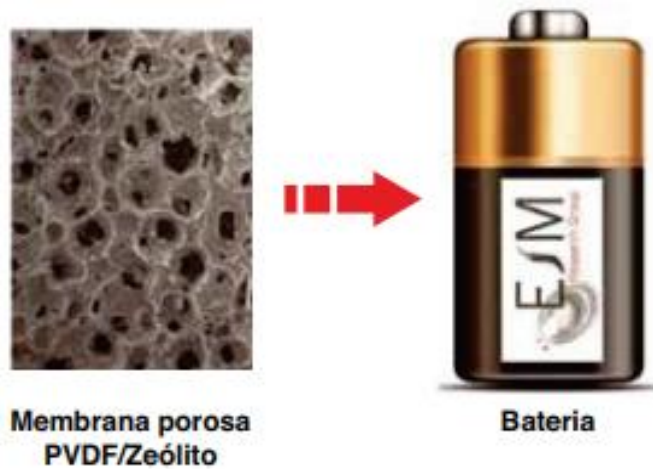
Figura 13 - Modelo de PVDF aplicado para separador em bateria
