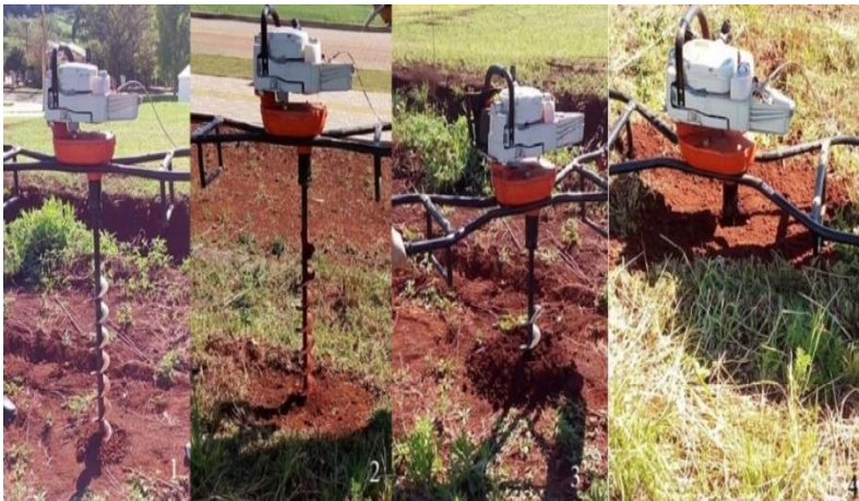
Figura 11 - Etapas da sondagem a trado
