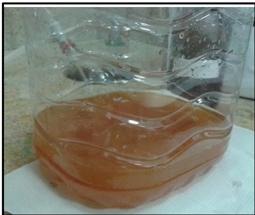
Figura 7- (a) Resíduo de cromo III, quando atingiu a cor vermelha devido a mudança no estado de oxidação.(b) Resíduo, depois de adicionado NaOH.
