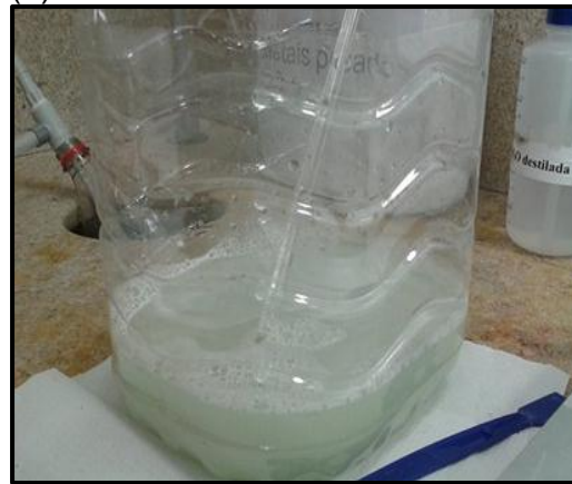
Figura 7- (a) Resíduo de cromo III, quando atingiu a cor vermelha devido a mudança no estado de oxidação.(b) Resíduo, depois de adicionado NaOH.
