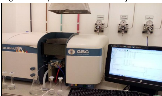
Figura 2 - Espectrômetro de absorção atômica com chama.
