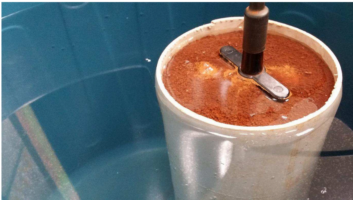
Figura 3 – Obtenção de leitura da constante dielétrica ( K_a ) de solo sob saturação.
