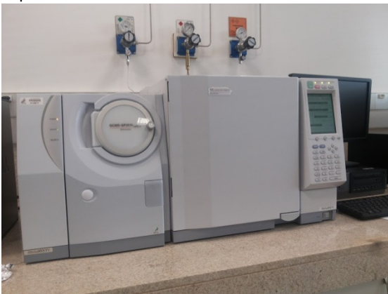
Fotografia 14. Cromatógrafo gasoso com espectrofotometria de massa, Marca Shimadzu, modelo do cromatógrafo QP2010 e espectrofotômetro GC2010.
