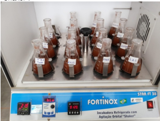
Fotografia 52. Agitação de amostras de solo em Incubadora Refrigerada com Agitação Orbital "Shaker".
