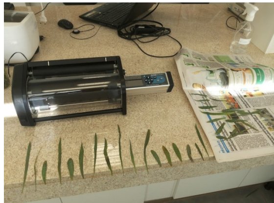
Fotografia 53. Análise da área foliar do milho com o auxílio de medidor de área foliar de bancada.
