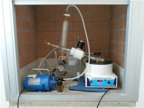
Fotografia 12. Esquema utilizado para rotoevaporação dos solventes (Rotoevaporador, bomba de vácuo).
