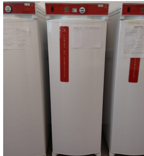
Fotografia 7. Câmara de Germinação tipo BOD - Marca Biofoco - Modelo BF2 CGFP 295.
