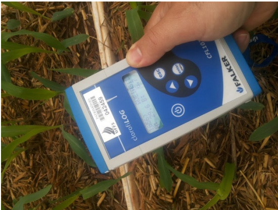
Fotografia 50. Avaliação do índice de clorofila das plântulas de milho em casa de vegetação.
