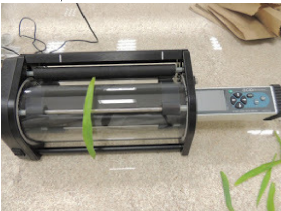
Fotografia 16. Medidor de área foliar de bancada marca CID, modelo CI-203.
