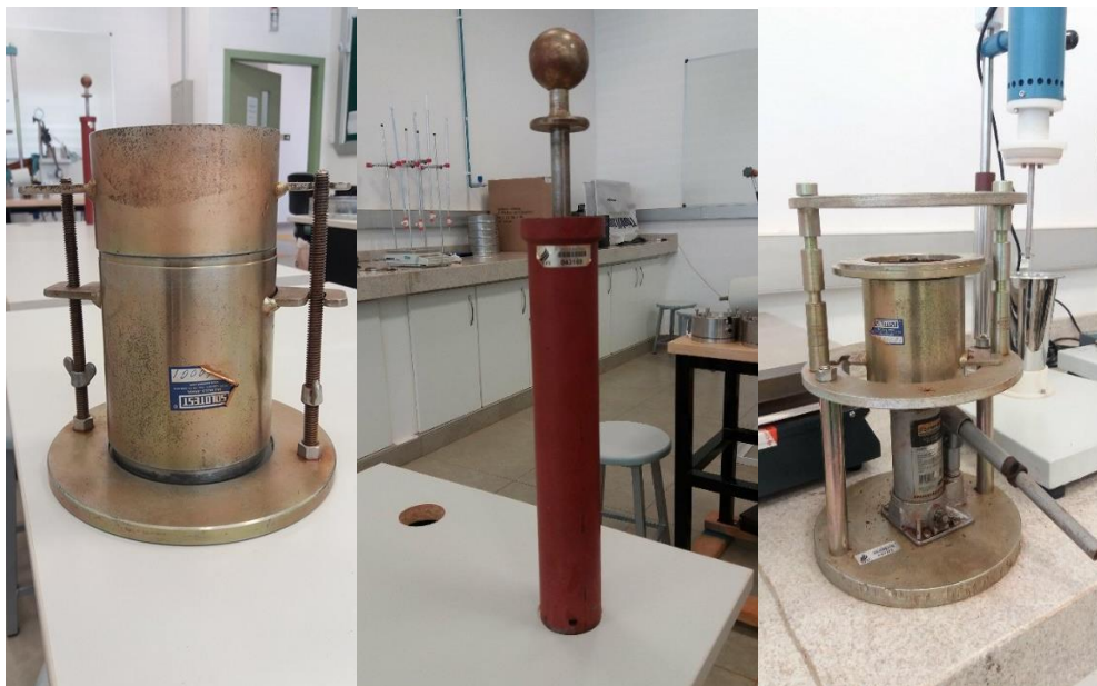
Figura 9 – Cilindro para ensaios de compactação, soquete para ensaios de compactação e extrator hidráulico
