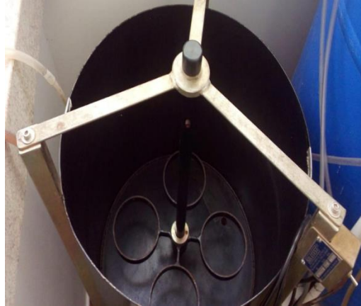
Figura 3 - Oscilador vertical do tipo (Yoder)
