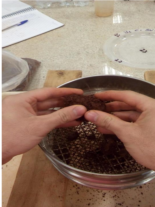
Figura 2 - Desagregação das amostras nos pontos de fraqueza
