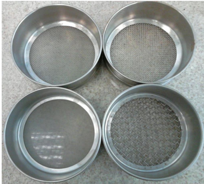
Figura 4 - Conjunto de peneiras com diâmetros 0,250; 1,00; 2,00; 4,76 mm
