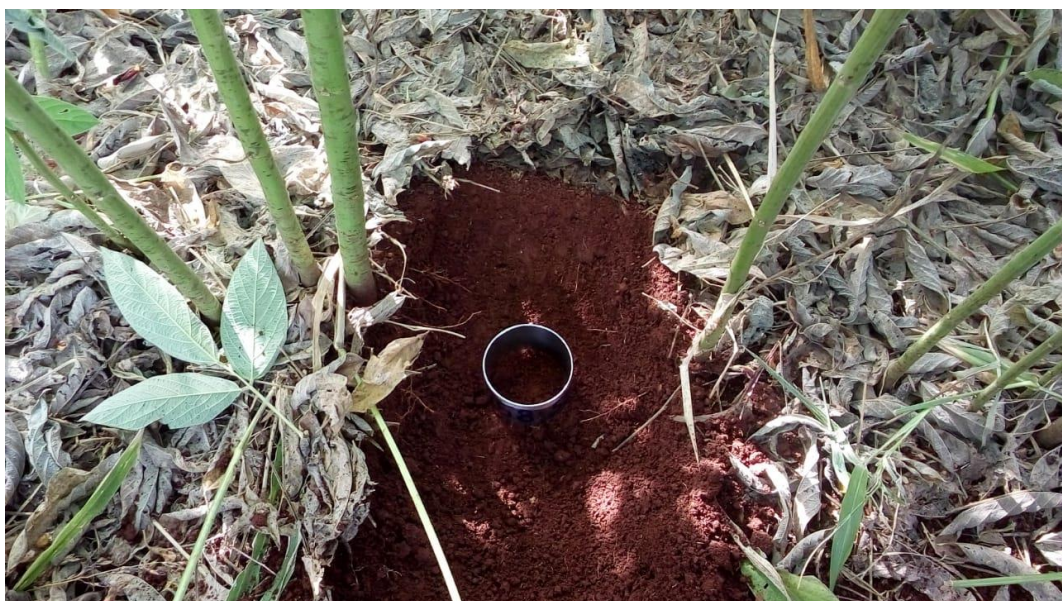
Figura 5 - Coleta das amostras de solo com estrutura preservada
