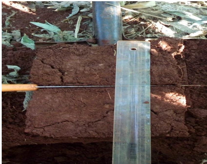
Figura 1 - Coletas dos monólitos de solo na entrelinha de semeadura
