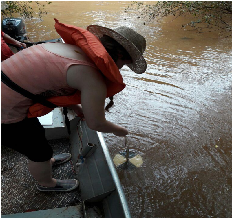
Fotografia 4- Leitura da transparência da água com a ajuda do Disco de Secchi no rio Comandaí, município de Guarani das Missões, RS
