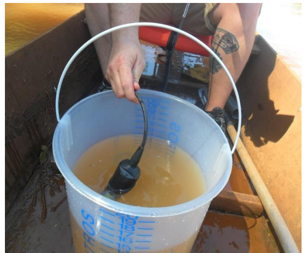
Figura 12- Multiparametro utilizado para definir a qualidade da água.
