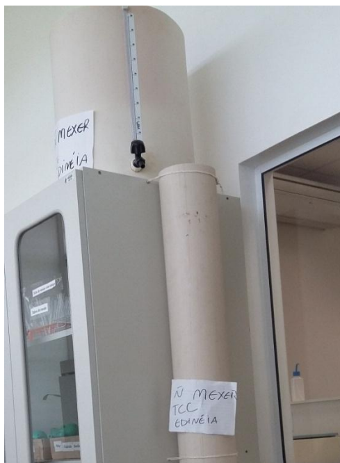
Figura 20 - Tambor usado como reservatório de efluente
