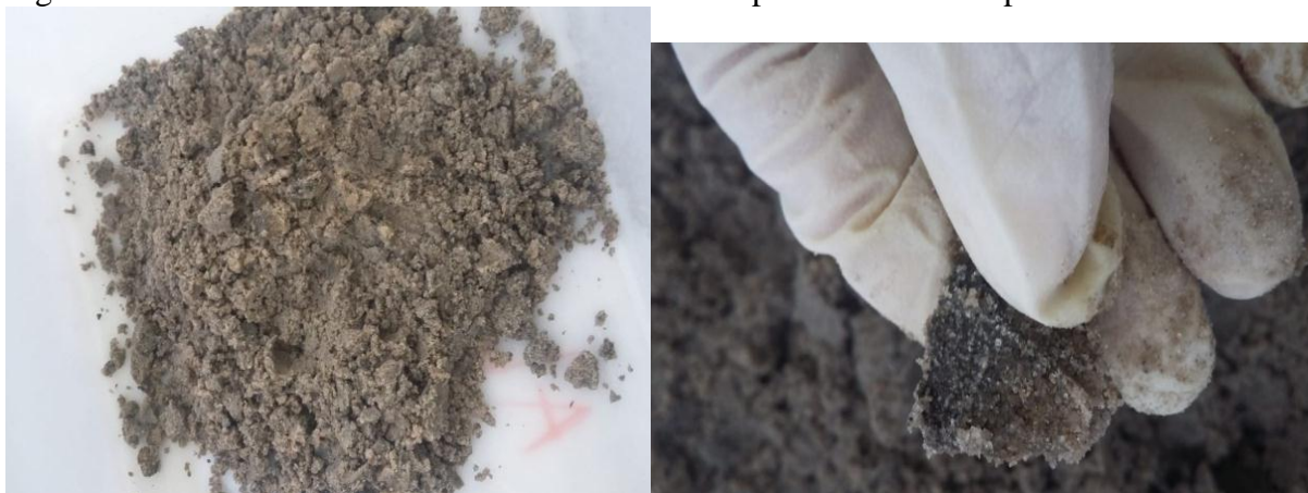
Figura 25 - Material filtrante retirado do Filtro Lento para realizar a limpeza.
