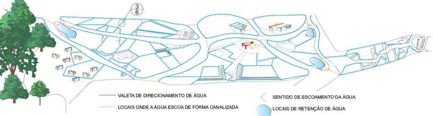
VALETA DE DIRECIONAMENTO DE ÁGUA | SENTIDO DE ESCOAMENTO DA ÁGUA | LOCAIS ONDE A ÁGUA ESCOIA DE FORMA CANALIZADA | LOCAIS DE RETENÇÃO DE ÁGUA
