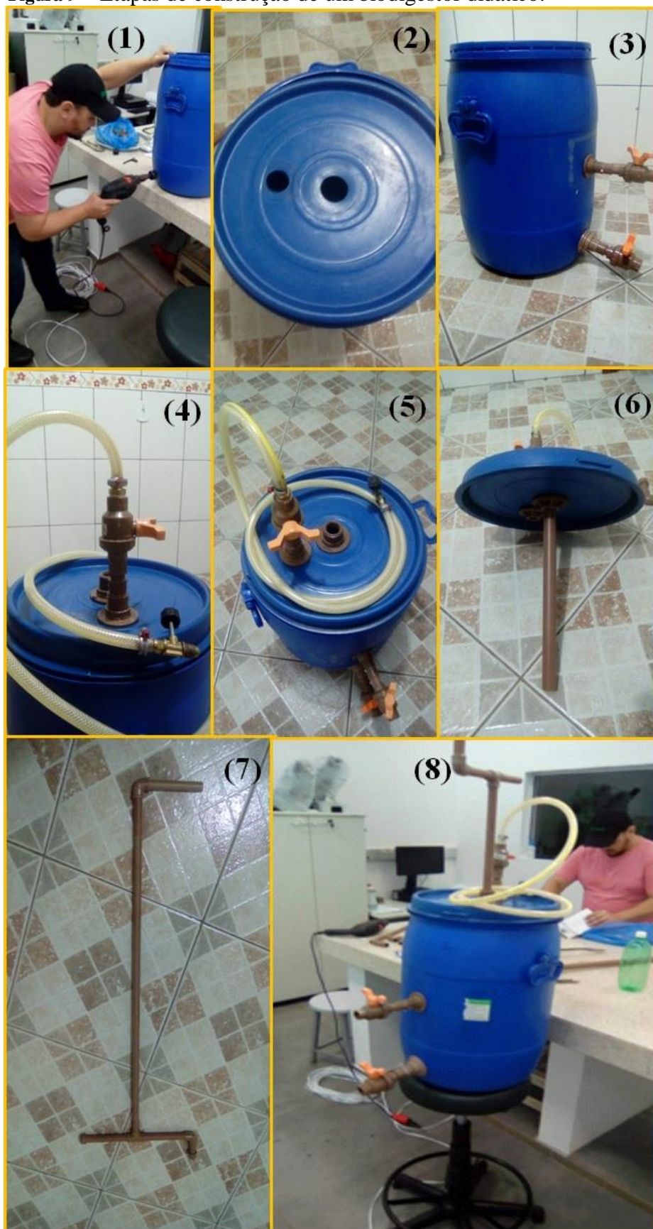
Figura 9 – Etapas de construção de um biodigestor didático.
