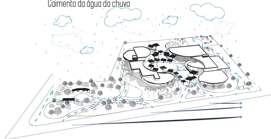
Em relação ao caminho das águas, todos os sentidos do terreno desembocam a norte, onde é descida. Por isso, utiliza-se de pedras para ajudar a guiar a água na grama e, quando há caminhos, a água continua guiada por tubulações.
