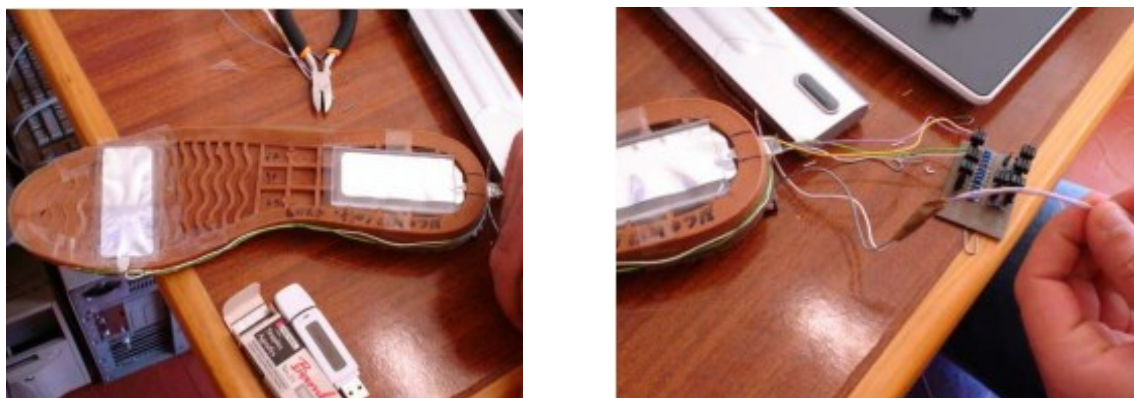
Figura 5 – Protótipo de gerador de energia na sola do sapato (ROCHA et al., 2010).
