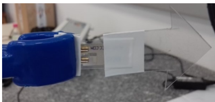
Figura 23 – Posição do material piezoelétrico no plástico PVC.
