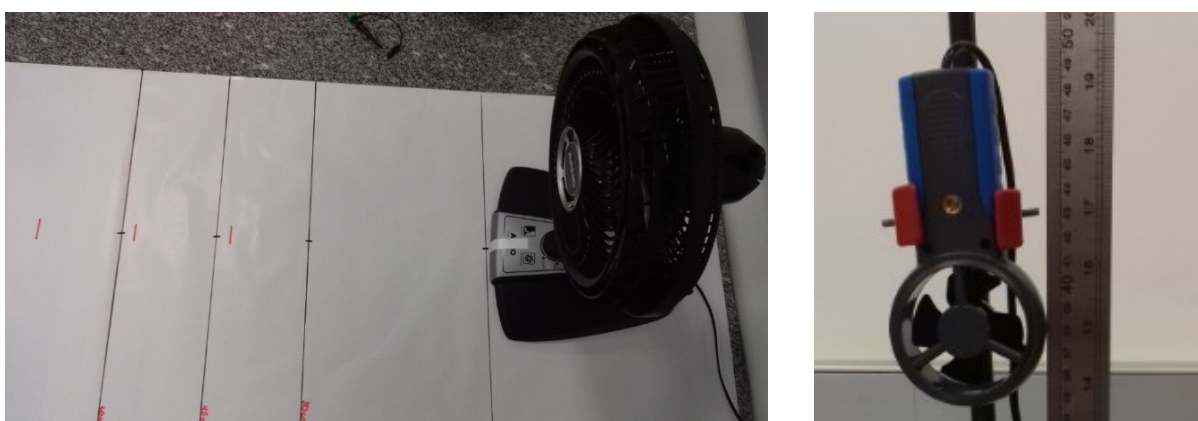
Figura 17 – Plataforma de estudo, medidas com o anemômetro.
