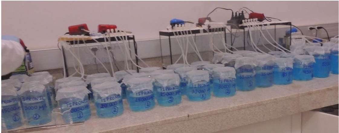
Figura 7: Frascos de vidro referentes ao ensaio agudo de P. gracilis expostos a formulação comercial do inseticida fipronil, com aeração artificial - Laboratório de Ecologia e Conservação da Universidade Federal Fronteira Sul, campus Erechim. Fonte: Elaborado pelo autor, 2018.
