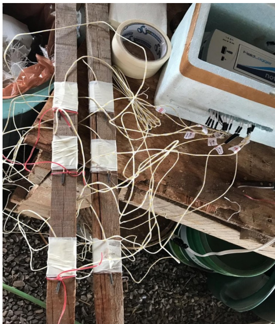
Figura 3 - Sensores do tipo K instalados na estaca.
