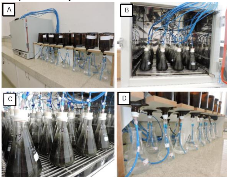
Figura 4 – Sistema utilizado nos experimentos de produção de metano. (A) Visão geral; (B) Disposição dos reatores anaeróbios no interior da estufa; (C) Detalhe dos reatores contendo inóculo (dejetos suínos) e substratos (pena de galinha); (D) Sistema de lavagem de biogás e medição do metano produzido
