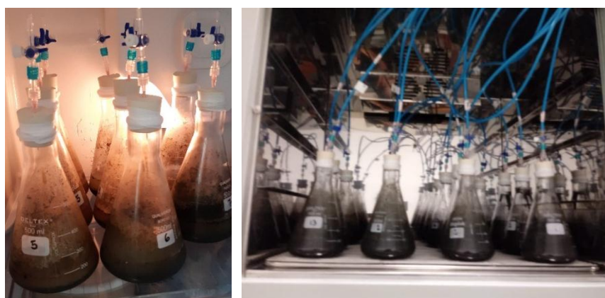
Imagem 2 – Esquema de montagem dos reatores anaeróbios
