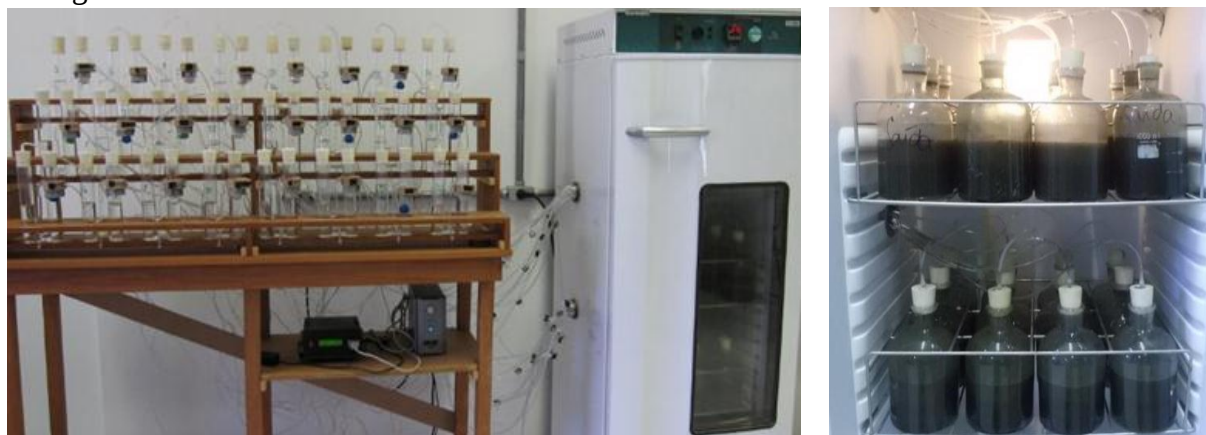
Figura 3 – Sistema de reatores com dejetos em incubadora conectados a um sistema de medição de biogás
