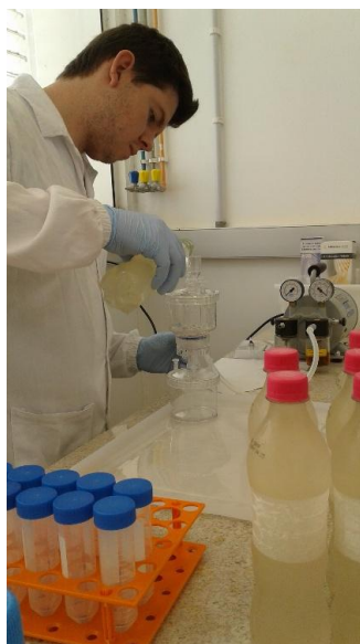
Figura 6 - Filtração a vácuo de amostra de corpo hídrico
