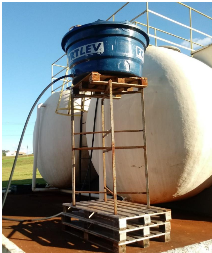
Figura 8: Sistema para determinação da variação de carga de leito limpo.
