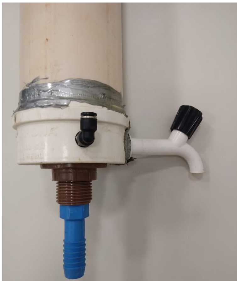
Figura 3: Bocal de saída da coluna, torneira e conexão para o piezômetro.
