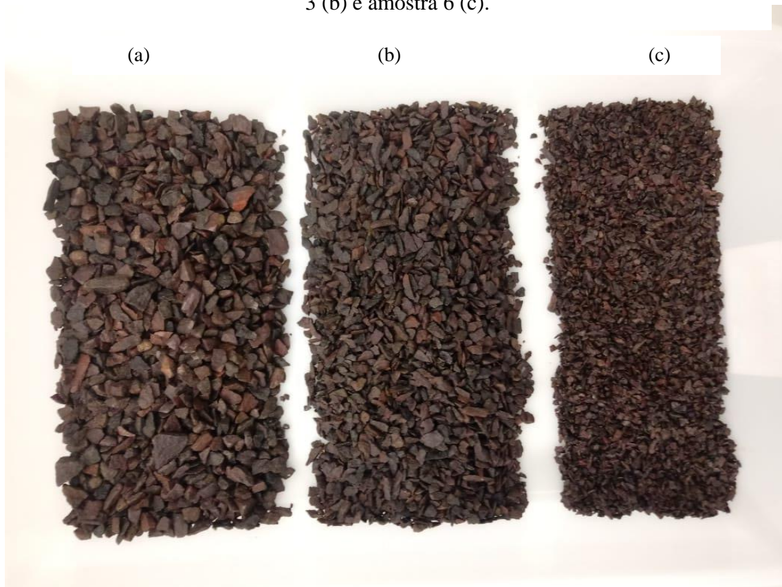
Figura 5: Amostras de rocha basáltica do maior para o menor, amostra 1 (a), amostra 3 (b) e amostra 6 (c).
