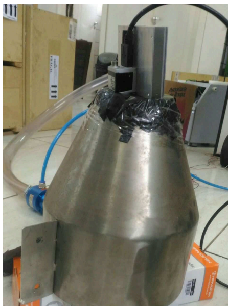
Figura 21 – Invólucro para amenizar a interferência da iluminação externa.
