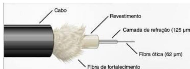
Figura 6: Composição do cabo da fibra óptica [12].
