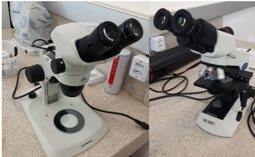
Figura 4 – Microscópio estereoscópio (esquerda) e microscópio biológico binocular (direita) utilizados para a identificação dos fungos
