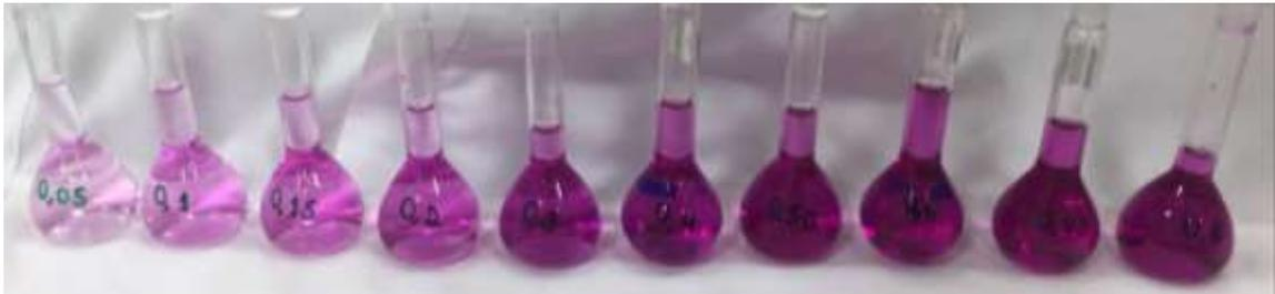
**Figura 5.** Sequência de concentrações utilizadas para construção da curva de calibração
