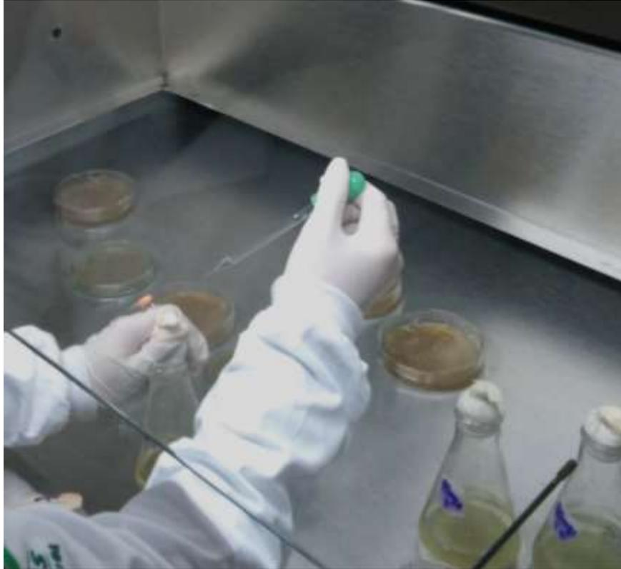
**Figura 7.** Procedimento de retirada de uma alíquota do meio fermentativo para transferir para uma placa contendo meio MEA e ser possível a avaliação da tolerância dos fungos
