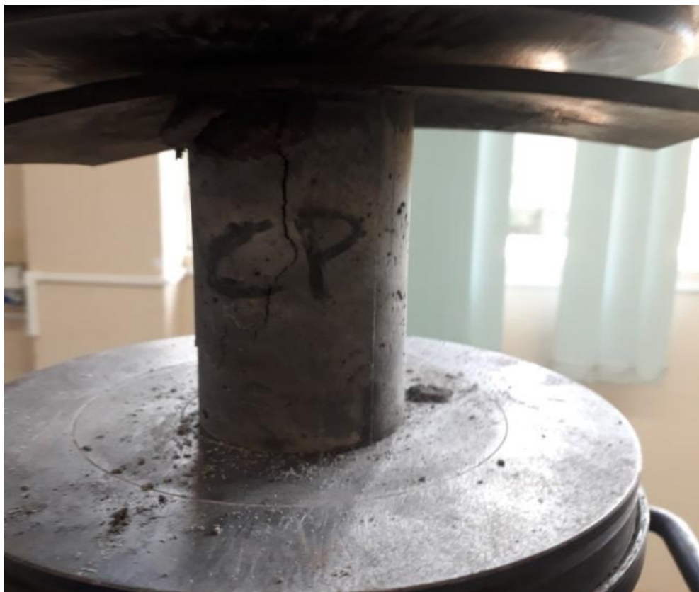
Figura 9 – Ruptura do corpo de prova sem substituição do agregado miúdo.
