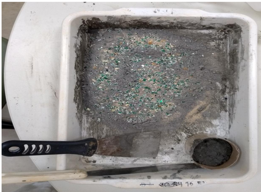
Figura 5 – Mistura da areia, cimento e placas de circuito impresso.
