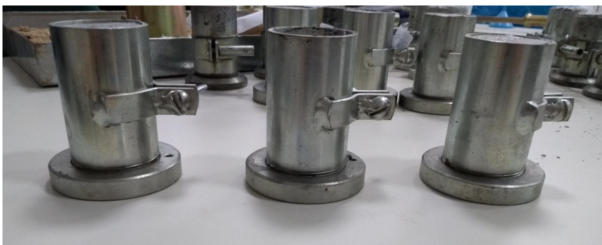
Figura 4 – Moldes utilizados na fabricação do concreto.
