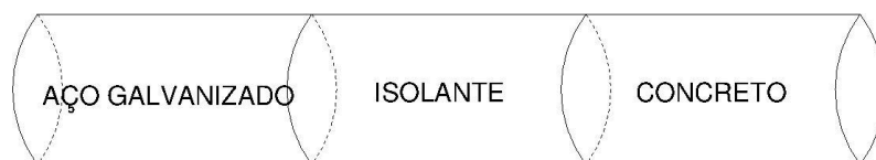
Figura 5 – Barra composta por três materiais.
