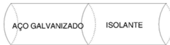
Figura 6 – Barra composta por dois materiais.
