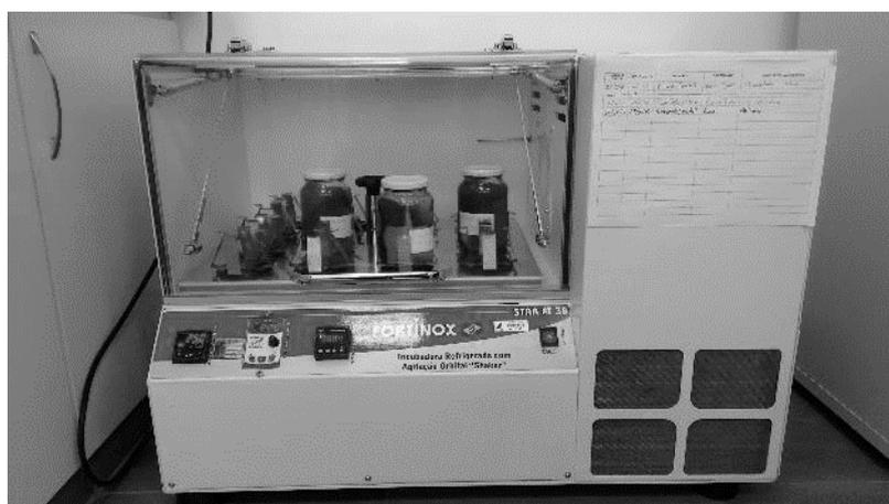
Agitador orbital incubadora tipo "shaker" modelo Star FT 38 marca Fortinox utilizado nos processos de extração. Laboratório de Fisiologia Vegetal da Universidade Federal da Fronteira Sul, *Campus* de Laranjeiras do Sul (PR). Fonte: do autor, 2016.
