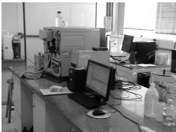
Cromatógrafo líquido modelo 920-R6 marca Varian® utilizado para identificação e quantificação de compostos nas amostras. Central de Análises da Universidade Tecnológica Federal do Paraná, *Campus* de Pato Branco (PR). Fonte: do autor, 2016.
