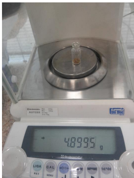
Figura 2 – Sementes pesadas após processo secagem na estufa a 105° C.
