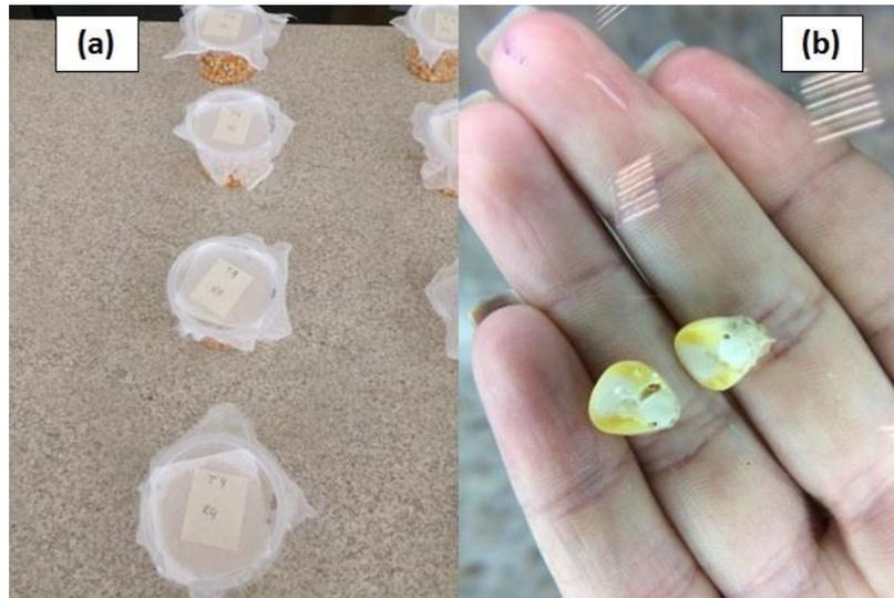
**Figura 3** – Teste experimental da ação inseticida de citronela sobre *Sitophilus zeamais* em laboratório: **(a)** Isolamento com tela de nylon e deposição do papel poroso sobre os recipientes; **(b)** Detalhe do grão infestado com ovos – elaborado pela autora, 2019.
