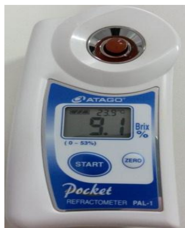
Figura 4.12 – Imagem da análise de sólidos solúveis, utilizando refratômetro digital, marca Pocket.
