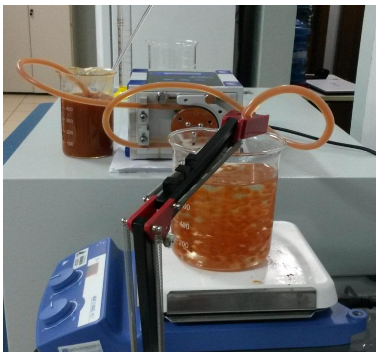
Figura 3.3 – Sistema para elaboração das esferas de néctar de pitanga.
