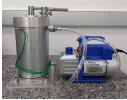
Figura 3.2 – Conjunto câmara de dispersão e bomba de vácuo.
