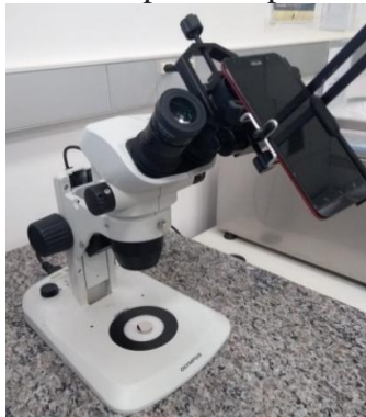
Figura 3.4 – Conjunto microscópio/câmera para a captura de imagens.
