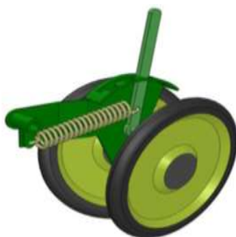
Figura 3 - Mola responsável por exercer pressão na roda compactadora
