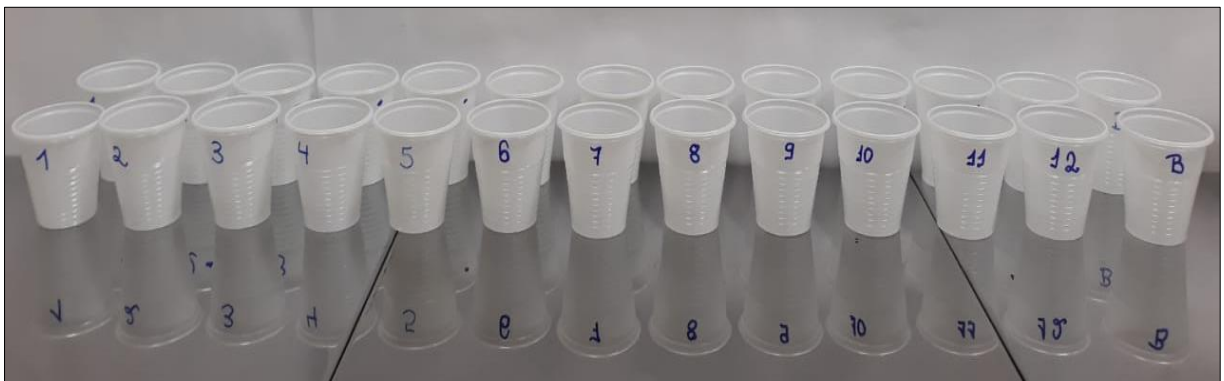
Figura 12 – Realização do teste agudo em recipientes-teste contendo o microcrustáceo Dm nas condições experimentais propostas no DCCR 2^2 + 4 axiais para a amostra de água de abastecimento público fortificada com os herbicidas glifosato e 2,4-D.
