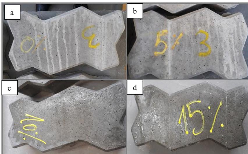
Figura 8 – Peças de concreto produzidas substituindo areia por resíduo de polímero reforçado com fibra de vidro, nas porcentagens de (a) 0%, (b) 5%, (c) 10% e (d) 15%.
