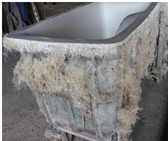
Figura 1 – Peça produzida em PRFV antes de passar por acabamento, contendo rebarbas.
