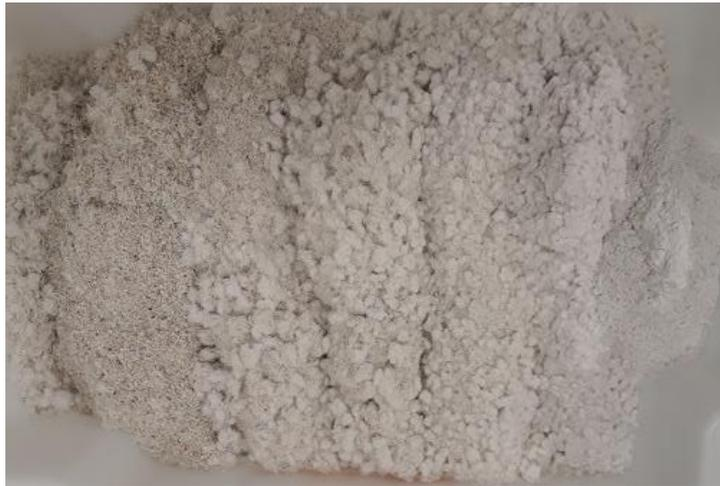
Figura 4 – Resíduo de polímero reforçado com fibra de vidro após beneficiamento em moinho de facas de abertura 2 mm, segregado do tamanho mais grosso para o mais fino, para ensaio de composição granulométrica.
