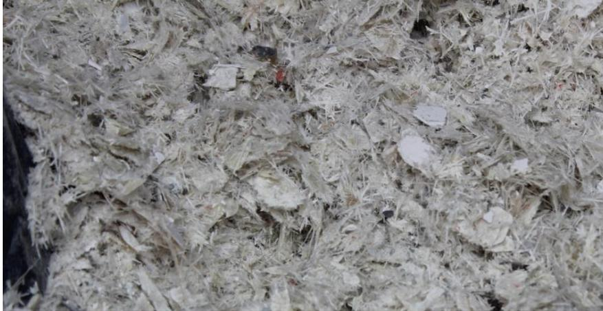
Figura 2 – Resíduo de PRFV moído em seu estado bruto, obtido na empresa.
