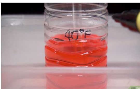
Figura 4- Termômetro caseiro a base de álcool.
