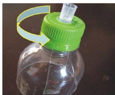
Figura 2 - Microscópio de garrafa pet para uso no ensino das Ciências Naturais.
