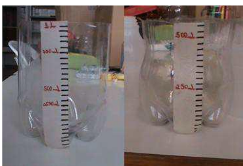
Figura 5- Béqueres de 1,5 e 0,5 litros fabricados com garrafas pet.
