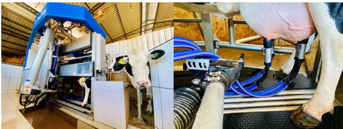
**Figura 4** – Ordenha mecânica voluntária (robotizada) em sistema intensivo *compost barn*.
