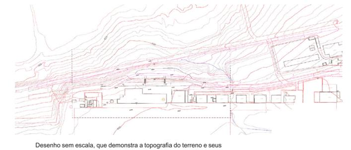
Desenho sem escala, que demonstra a topografia do terreno e seus taludes; Visando agora um planejamento de um talude chanfrado, trabalhando assim para uma perspectiva mais elementar do terreno no ponto de vista de quem está chegando.
