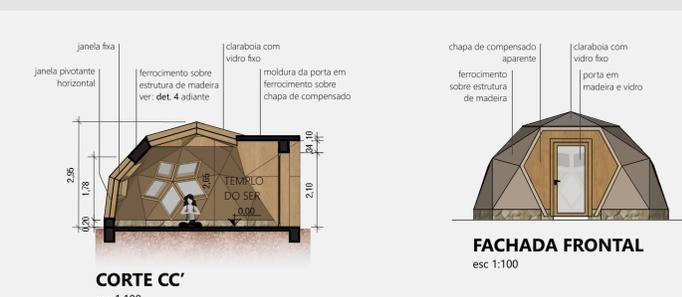
Seguindo a mesma solução adotada no projeto todo, o Templo do Ser é também idealizado em um sistema estrutural leve de madeira, porém agora em um domo geodésico (com conexão tipo goodkarma - ver det. 6). O fechamento se dá, do mesmo modo como nos outros edifícios, com chapas de compensado em ambos os lados das barras e palha com barro como isolante termo-acústico. O revestimento/cobertura adotado foi o ferrocimento, por sua praticidade e durabilidade.
