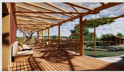
No deque, o pergolado de bambu com policarbonato translúcido protege da chuva e deixa o deque mais aconchegante sem, contudo, impedir a passagem da luz e a visão dos ipês amarelos.
