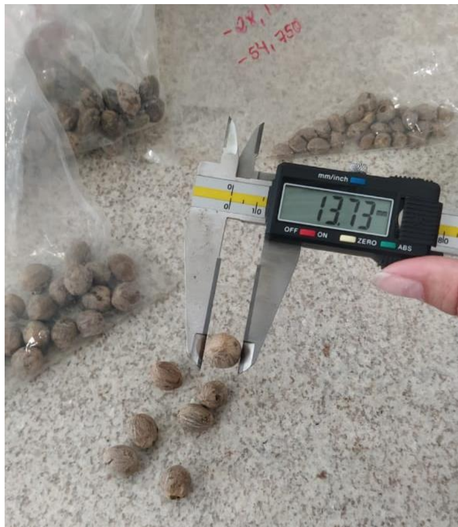
Figura 4- Paquímetro digital mensurando os pirênios de Butia spp. da Região das Missões.
