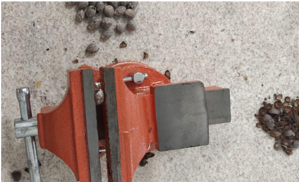
Figura 7- Torno de bancada utilizado para a quebra dos pirênios e retirada das sementes (amêndoa).
