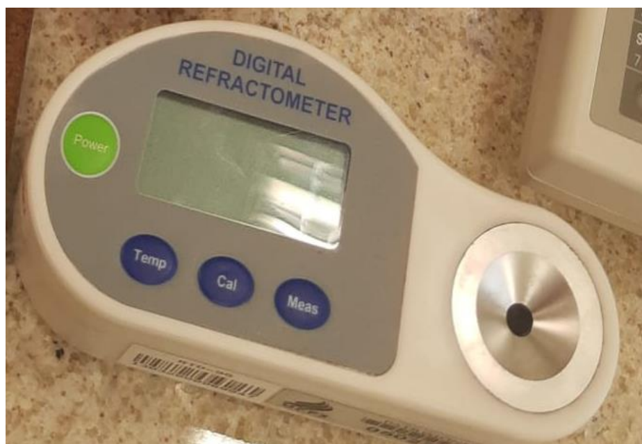
Figura 5- Refratômetro digital utilizado para mensurar os teores de sólidos solúveis dos frutos de Butia spp. da Região das Missões.
