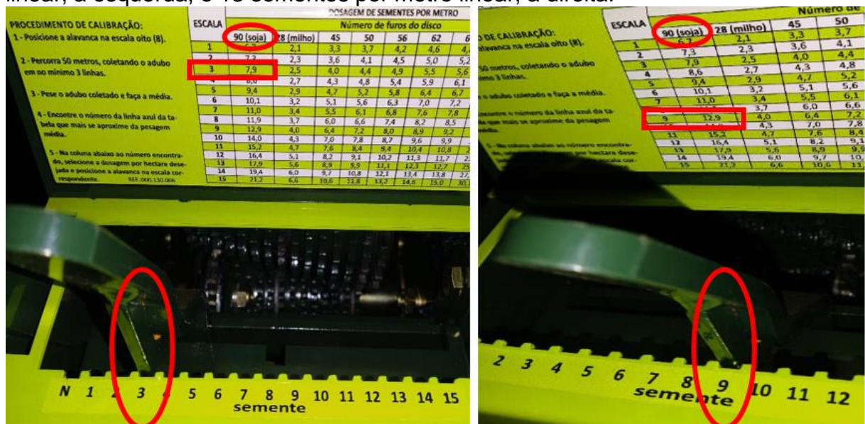
Figura 2 – Ajuste das engrenagens da semeadora para distribuir 8 sementes por metro linear, a esquerda, e 13 sementes por metro linear, a direita.
