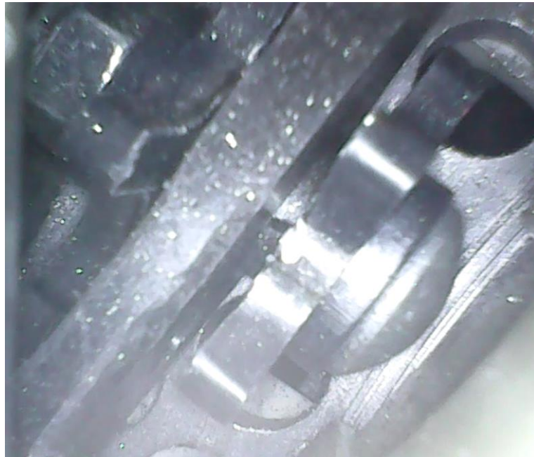
Figura 7- Disco convencional apresentando alvéolos vazios em operação de semeadura de 8 km h-1.
