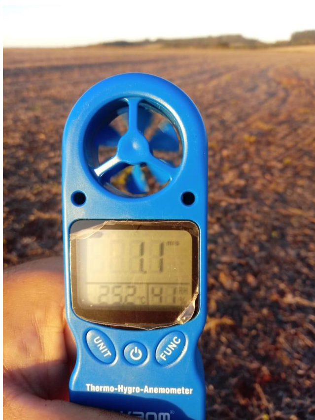
Figura 6 - Velocidade do vento e umidade do ar
