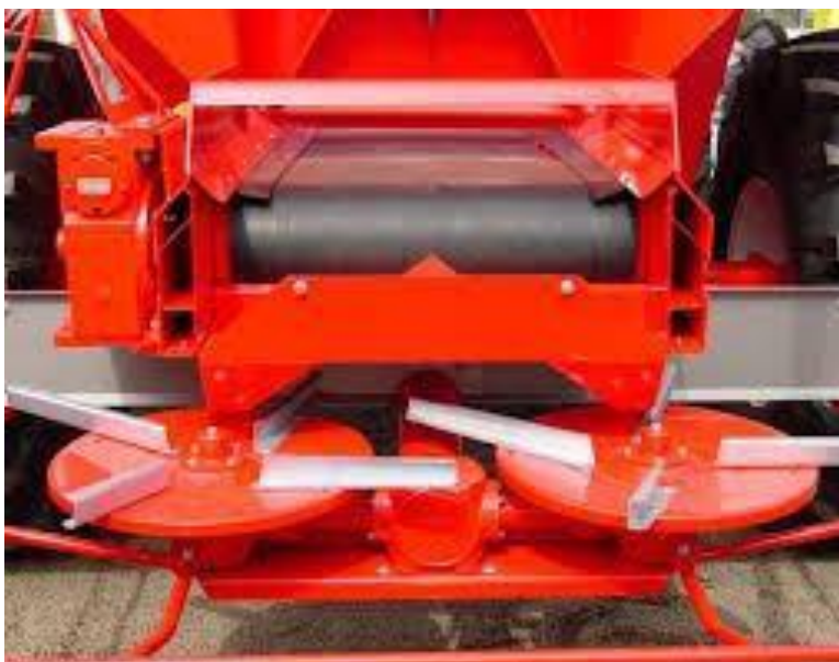
Figura 2- Mecanismo distribuidor por força centrífuga com dois discos.
