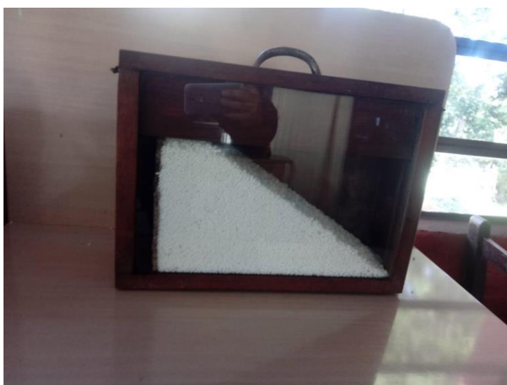
Figura 4 – Determinação do ângulo de repouso da uréia.
