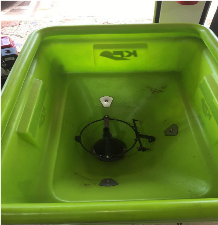
Figura 1- Dosador gravitacional de um distribuidor centrífugo.
