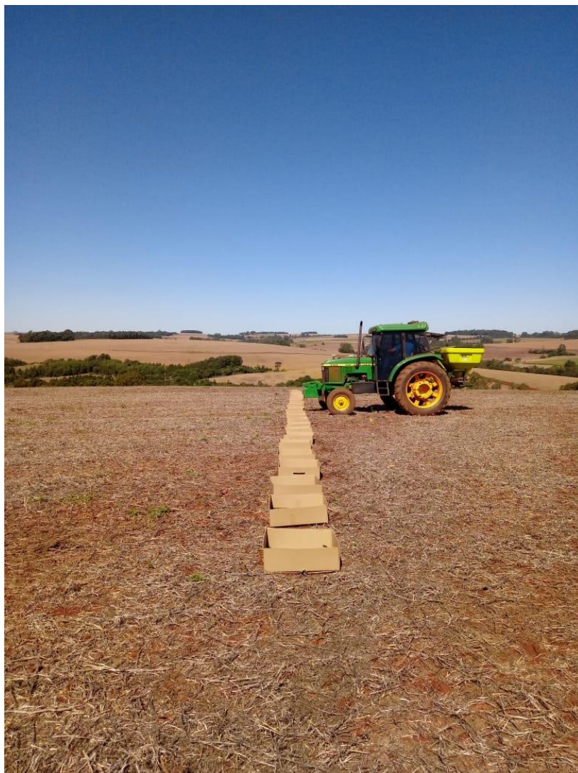
Figura 6 – Distribuição das bandejas coletoras
